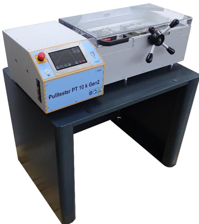
Der **Pulltester PT10k Gen2** ist ein präzises motorisches Messgerät für Zugprüfungen an Crimpverbindungen mit sehr großen Kabelquerschnitten, wobei der Messbereich bis auf 10.000 N ansteigen kann.
